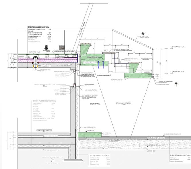
DETAIL 02 ANSCHLUSS ÜBERDACHUNG TRIBÜNE
